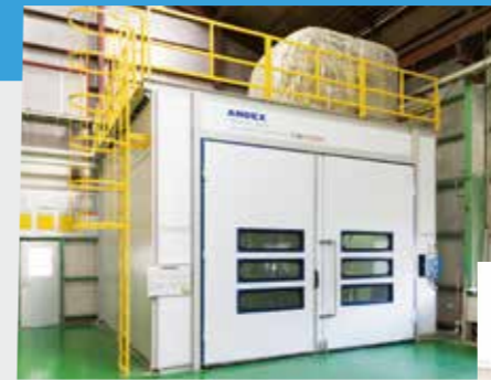
循環加温ヒートポンプ乾燥炉「CAB-OVEN」
