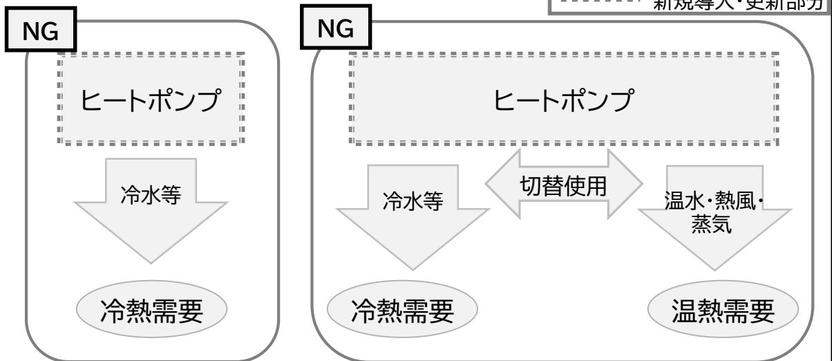
産業ヒートポンプ設備を冷却専用用途、もしくは冷却用途と加熱用途を切り替えて使用する等、1年間の中で加熱用途に使用しない時期が生じる産業ヒートポンプ設備導入事業
