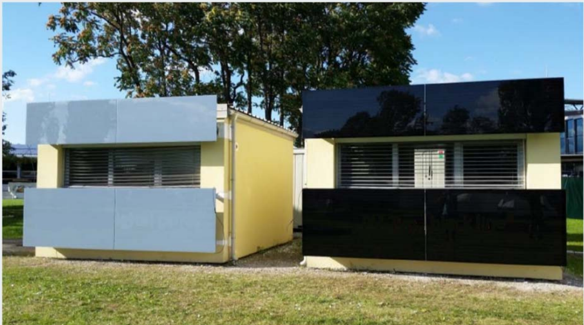
図1：冷却用のファサード一体型ヒートポンププロトタイプを含むテストボックス。Graz では2種類のPVがテストされる。
