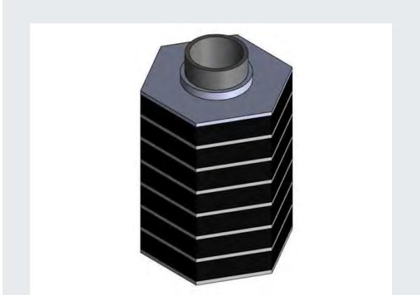
図 2: 「ケバブの設計」: アンモニア吸着用のコンパクトな活性炭を備えた新しいフィン付きチューブおよびシェル吸着器 (Warwick 大学)
